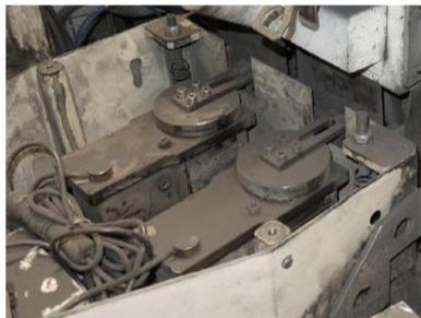
Durante l'ispezione (e dalle esperienze precedenti) si è rilevato che le vibrazioni della piattaforma, dovute ad esempio ai movimenti di una persona, provocano delle ampie oscillazioni della bilancia.
